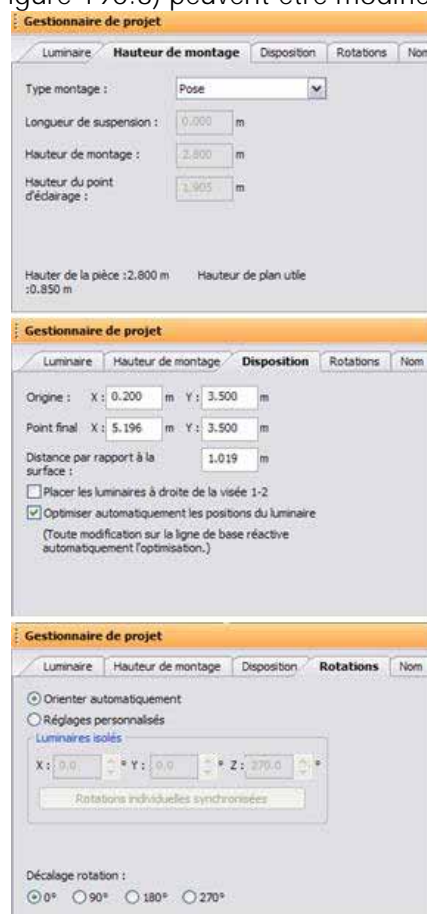
Figure 190 Modification de la hauteur de montage (1), de la disposition des luminaires (2) et de la rotation de luminaires individuels (3) dans une situation d'éclairage vertical de surface
