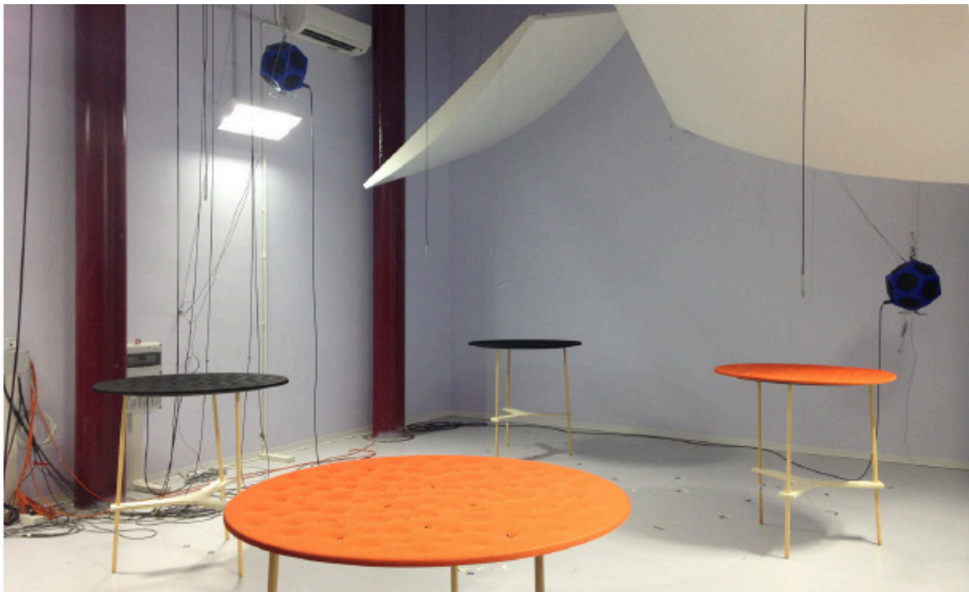
Figura 2: Disposizione delle 4 lampade Silent Field 2.0 in camera riverberante.
