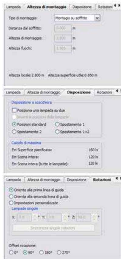
Immagine 196 modifica altezza di montaggio (1), disposizione lampade (2) e rotazione singole lampade (3) in situazioni di illuminazione diretta superficiale
