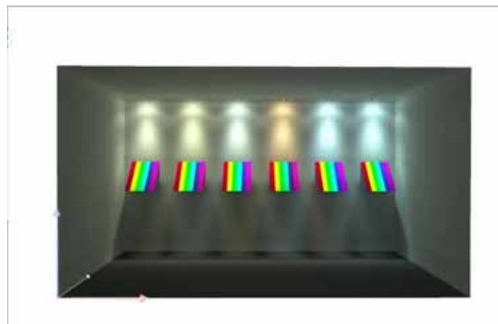
Immagine 215 Diversi spettri delle lampadine, stesso filtro colorato. Da sinistra: Lampadina a incandescenza, Sostanza luminescente 830, D65, HST, HCL, HIT
