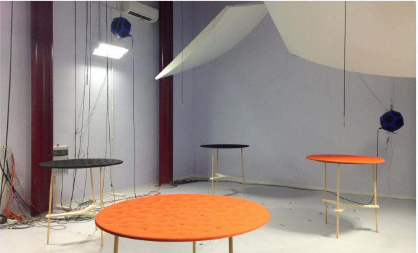
Figura 2: Disposizione delle 4 lampade Silent Field in camera riverberante.
